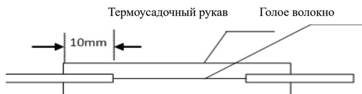
Рис. 7-7 Использование защитной втулки
